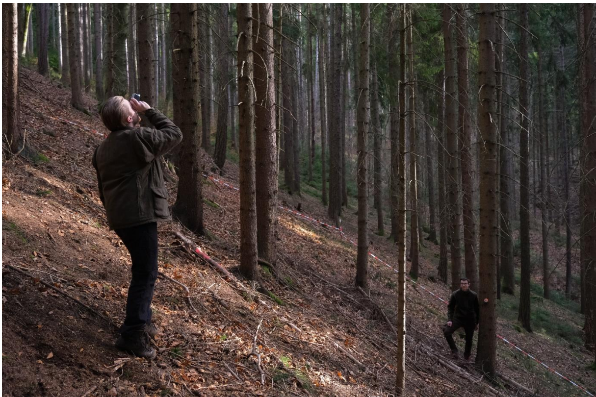
Abbildung 9: Messung von Baum- und Kronenansatzhöhe mit Vertex
