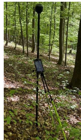
Abbildung 2-2 Aufnahmeeinheit RTK- GNSS-Gerät Emlid Reach RS3
