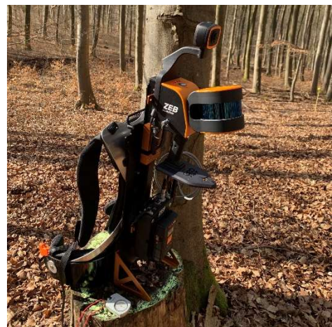
Abbildung 2-5 Aufnahmeeinheit des Laserscanners GeoSLAM ZEB Horizon RT als Rucksackgetragene Variante am Startpunkt des Scans
