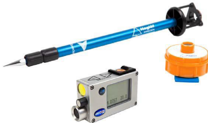
Abbildung 5: Vertex IV mit Transponder T3 und Adapter auf Stativ (Haglöf Sweden AB 2007).
